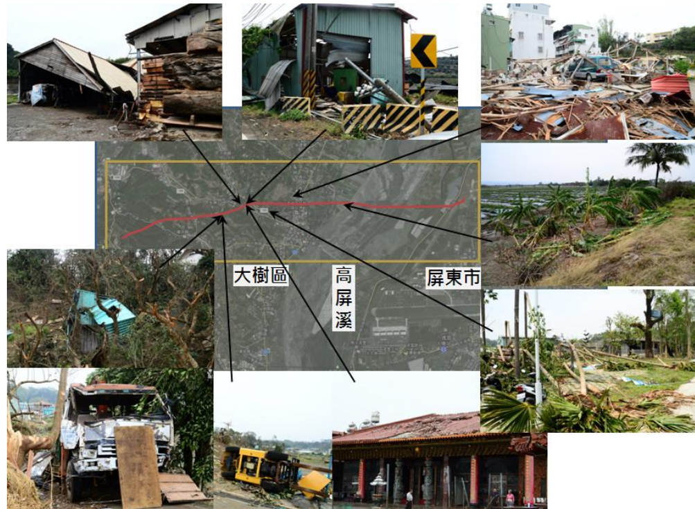
圖 4 龍捲風受災區現勘調查照片彙整。受龍捲風影響，受災標的物分佈由西向東，並隨著龍捲風強度之變化而呈現不同程度之災損(圖中紅線為事後依現勘災點分佈重建之龍捲風移動路徑)。
